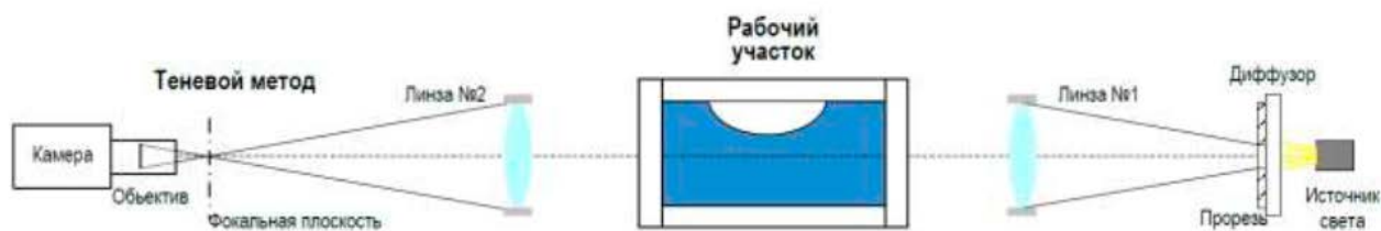
Рис. 12. Оптическая схема теневого метода для определения формы пузырька, [29,30].
