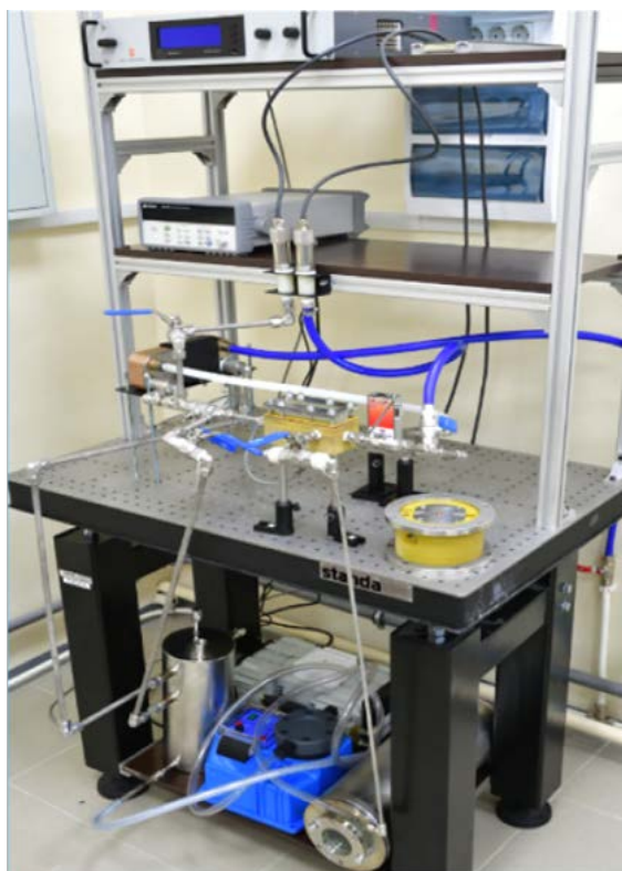
Рис. 6 Фотография экспериментального образца испарительной системы охлаждения теплонапряженных элементов с использованием однокомпонентных двухфазных потоков.
